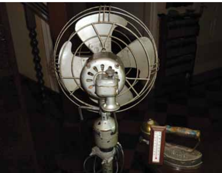
Ventilador antiguo e ineficiente: brinda poco caudal de aire y su motor recalienta.
